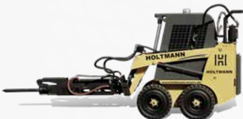
Maschinentyp „Mini“ Ausbruchmaschine Debricking machine
